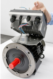
Kuva 22: Moottorin johtojen ohjaaminen
